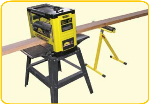
Пример использования роликовой опоры с рейсмусовым станком
